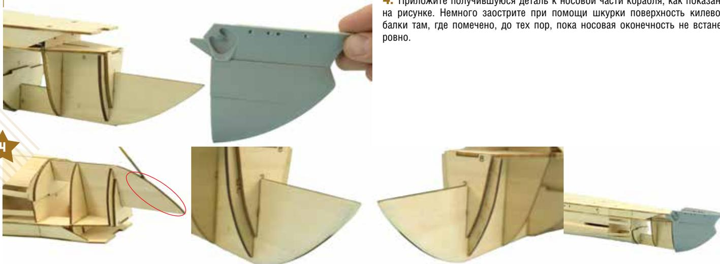
**5.** Еще раз убедитесь в том, что носовая оконечность идеально встает на свое место, затем приклейте ее моментальным универсальным клеем к соответствующим элементам каркаса корпуса, как показано на рисунке.
